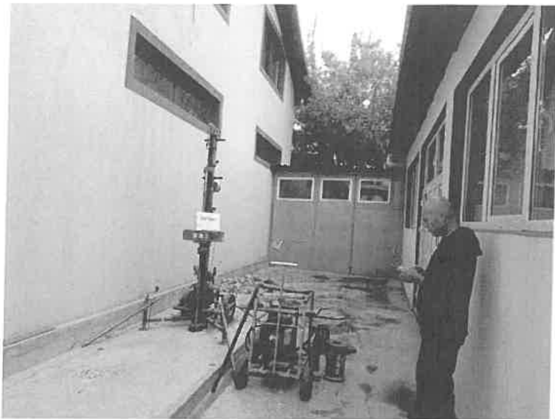
Fig. 13. Penetrare dinamică DPH01 – F01
